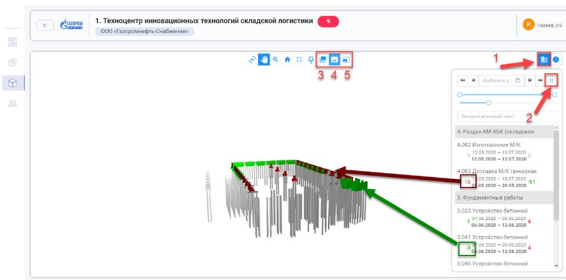
Рисунок 14. Визуализация календарно-сетевых графика на информационной 3D модели
